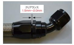
ソケットの後部にテープやマーカーでホースにマーキングしてくだ ニッブルに潤滑油を塗布し手でニップルとホースを組み込んだソケットを組み込みます。 できるだけ手で締めてください。その後スパナ さい。この後ホースを組み立てる際にホースがソケットから押し出 を使用しソケットとニップルの六角部とのクリアランスが1.5mm~2.0mmになるように締めてください。1.5mm以下のクリアランス まで締めないでください。※組み込み後、洗浄し最大圧力の2倍の圧力で30~60秒間検査してください。
