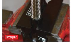
ソケットを万力に固定しホースを差し込みます。ホースを右回りに 回しながらソケットの奥に突き当たるまで差し込んでください。
